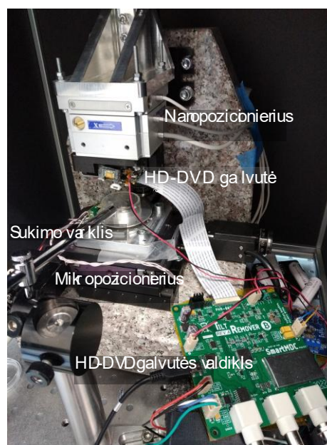
2 pav. Našios AFM sistemos eksperimentinis stendas
