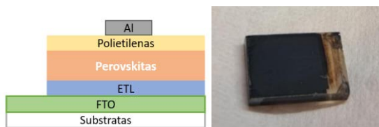
1 pav. Bandinio struktūros schema (kairėje) ir paruošto bandinio nuotrauka (dešinėje).
